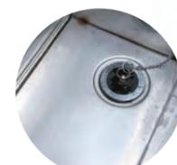
タンク内の排水口にゴム栓を採用。栓を抜くだけで簡単にタンク内の汚水を排出できます。
