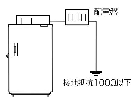
配電盤などのアース専用端子を利用する。
