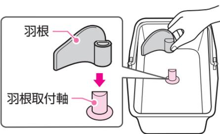
■羽根取付軸と羽根の穴の形を合わせて奥まで確実に差し込みます。
