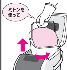
■ミトンを使って、パンケースのふちにある矢じるし(ゆるむ)の方向に回して取り出します。
