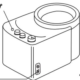
※バッテリーチャージャーを図のように充電用端子とコンセントに接続します。10時間以上で充電が完了し、約30時間、連続使用ができます。
