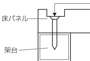
溝の底面よりネジの頭が出ないようにねじ込む。(締め過ぎに注意)
