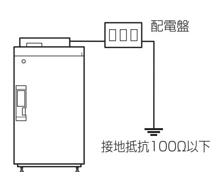
配電盤などのアース専用端子を利用する。
