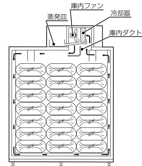
→ 冷気の流れ(本図はARC-21DSFを示します。)
