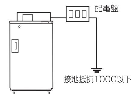
配電盤などのアース専用端子を利用する。
