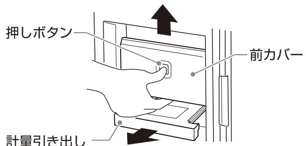
④計量引き出しと計量フレームを引き出す
