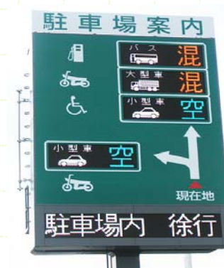
駐車場案内システム
