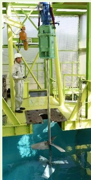
大型水槽による攪拌機の試験風景
